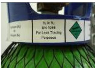
Un mélange d'hydrogène ou d'hélium avec l'azote peut permettre de trouver la fuite à une pression plus faible. Un détecteur de fuite approprié doit être utilisé – votre détecteur habituel n'est pas sensible à l'hydrogène ou l'hélium. L'azote peut être fourni avec des traces
