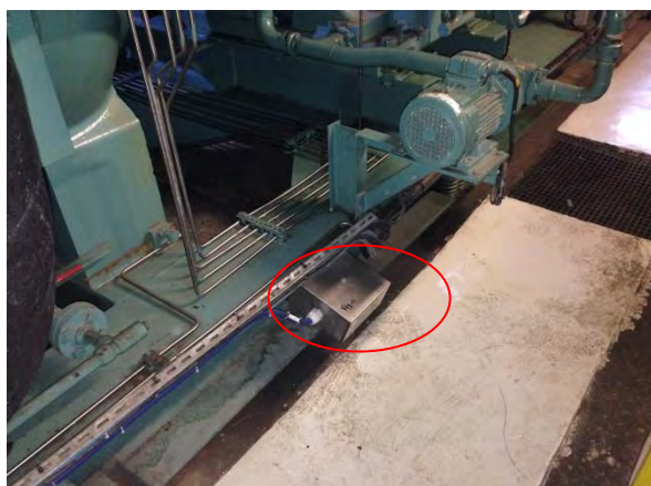
Figure 33 – Position des sondes d'aspiration protégées par un boîtier
