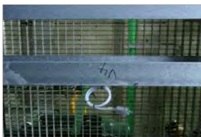
S4: Sonde N°4 sous caillebotis au plafond côté couloir
