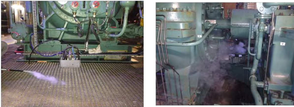
Figure 34 – visualisations de l'écoulement d'air à l'aide du fumigène
