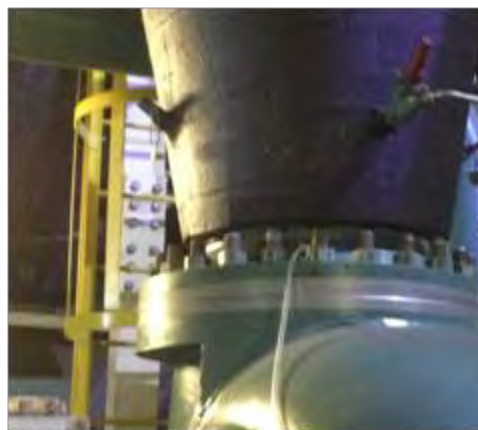
Figure 32 – Exemples de positions de la fuite calibrée au cours des tests
