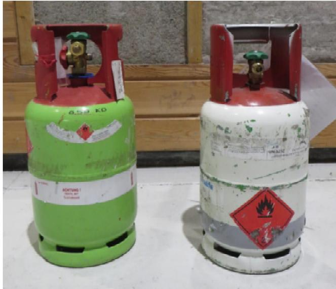
**Figure 39 : Bouteille de récupération R-32 (à gauche) et bouteille de fluide R-32 (à droite)**
