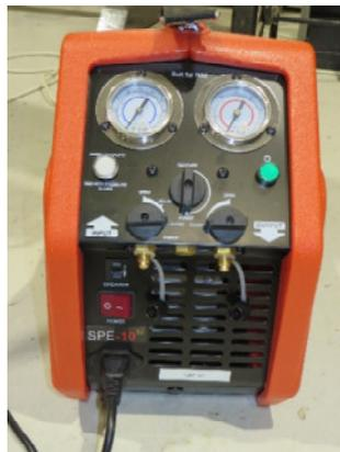
**Figure 46 : Station de récupération adaptée au R-32**
