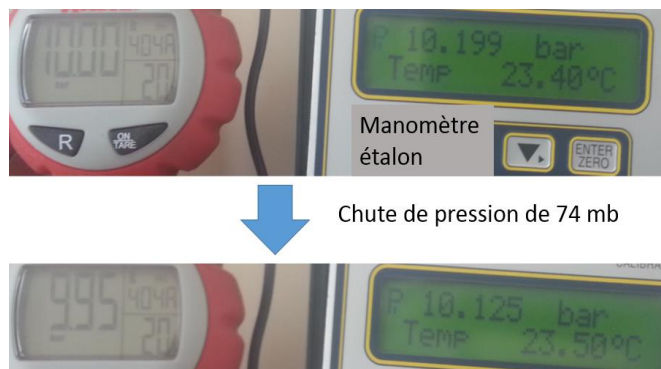
FIGURE 8. RESULTAT AVEC MANOMETRE NUMERIQUE
