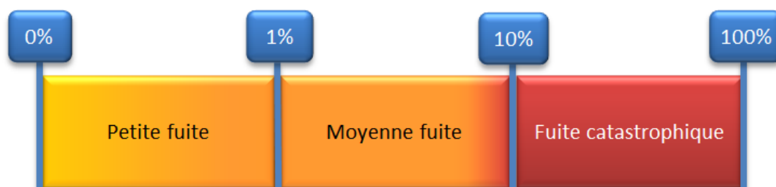
Figure 3-5 : Typologie de fuite en fonction des ratios diamètre de fuite/diamètre de la tuyauterie
