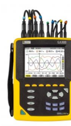
Figure 13-3 : Analyseur de puissance
