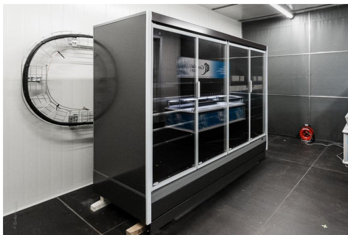
Figure 13-11 : Cellule climatique d'essai pour Meuble frigorifique de vente
